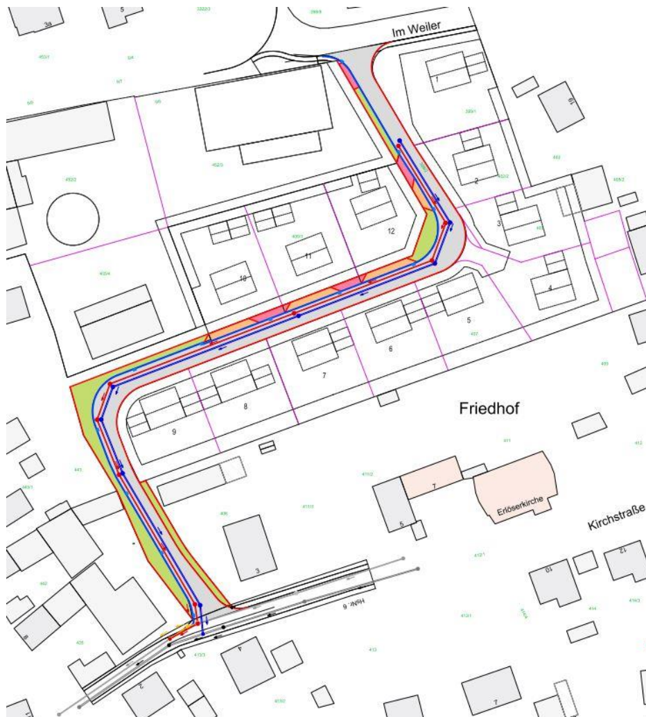
Abbildung 5: Übersicht Erschließung Baugebiet "Bräuche"
